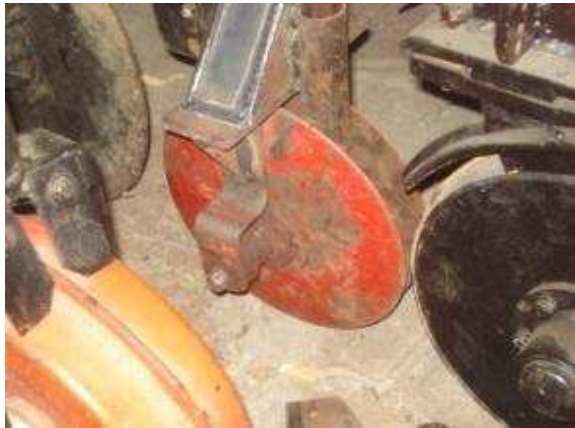
Unidad de fertilización de poca profundidad.
