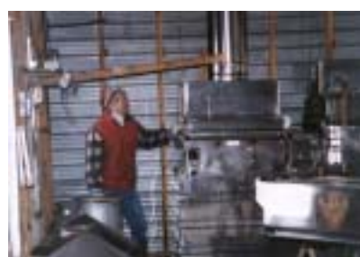
Figure 5.3 An evaporator in a sugarhouse in Quebec, Canada (photo courtesy of Victor Brunette, La Fédération des Producteurs de Bois du Québec, Longueuil, Québec, Canada).
